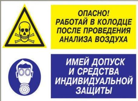
Работы, связанные со спуском работников в колодцы, опорожненные напорные водоводы и канализационные коллекторы, относятся к разряду опасных, к которым предъявляются дополнительные (повышенные) требования безопасности труда, и должны проводиться по **наряду-допуску** на выполнение работ повышенной опасности
