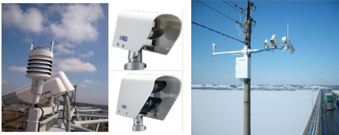
Рисунок 6.4.11. Бесконтактные датчики для измерения параметров состояния поверхности дороги
