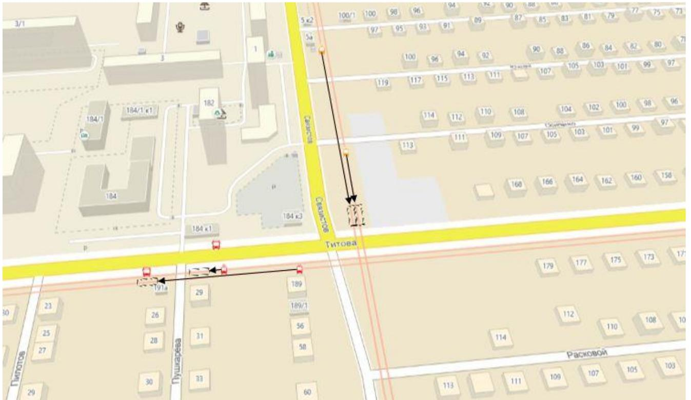
Рисунок 6.10.9. Принципиальная схема оптимизации размещения остановочных пунктов общественного транспорта
