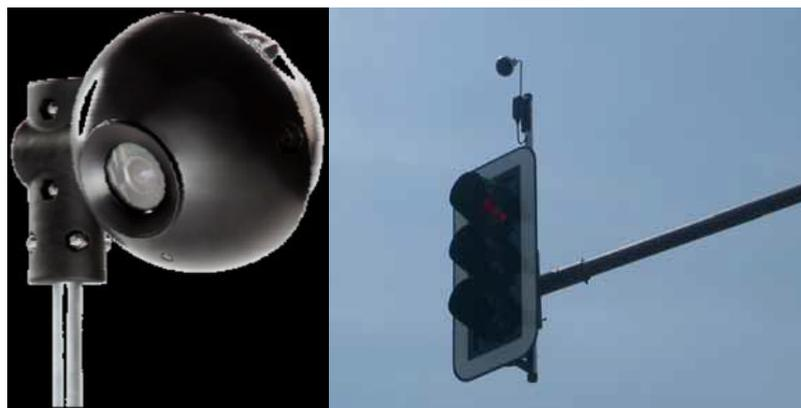
Рисунок 6.4.4. Внешний вид и пример размещения детектора транспорта TraftiCam x-stream
