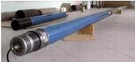
инклинометр, прибор радиоактивного каротажа ГК+2ННКТ, термометр и резистивиметр.
